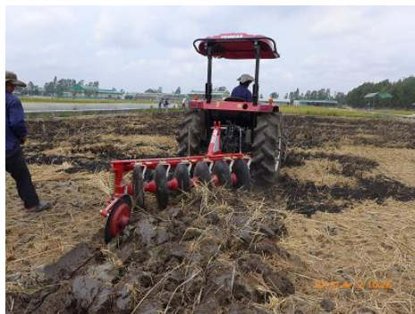
Cày phơi ải (máy kéo + cày đĩa)
