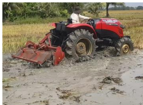
Trục lần 2 hoặc phay (máy kéo + bánh lồng/phay)
