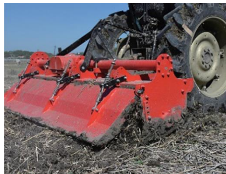
Cày trở/bừa/phay (máy kéo + cày đĩa/bừa/phay)
