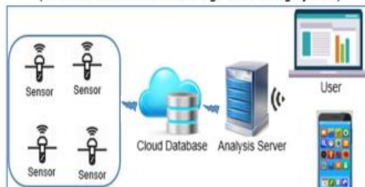
Hệ thống quan trắc và cảnh báo môi trường nước (Water environment monitoring and warning system)
