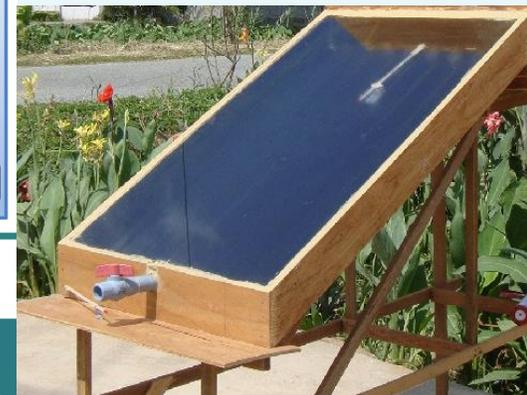
Sản xuất nước ngọt từ nước mặn
