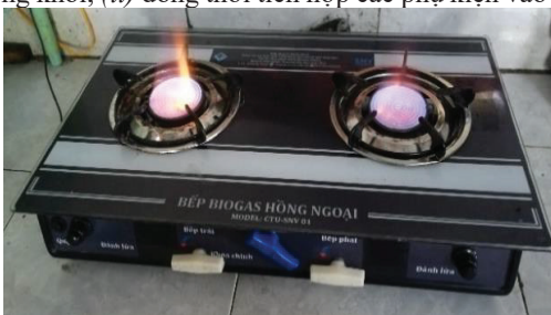
Hình 11. Bếp biogas hồng ngoại cải tiến; hình bên trái đốt biogas thông thường; hình bên phải đốt biogas hồng ngoại
