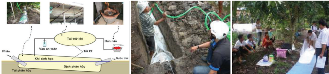
Hình 2. Mô hình túi ủ biogas lắp đặt cho các hộ gia đình - dự án CDM
